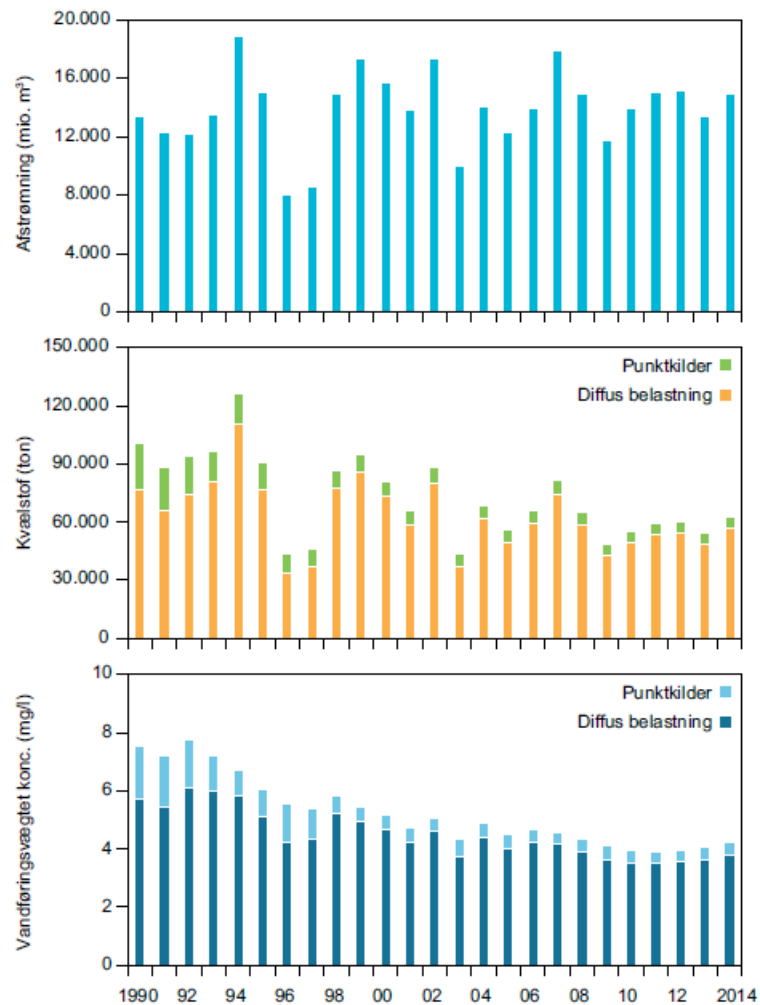
Figur 2.1. Udvikling i ferskvands-afstrømning (øverst), kvælstoftilførsel (midterst) og vandføringsvægtet kvælstofkoncentration i det afstrømmende vand til havet omkring Danmark (nederst) 1990-2014. Kvælstoftilførslen er fordelt på diffuse kilder (inkl. spildevand fra spredt bebyggelse) og spildevand fra øvrige punktkilder (Wi-berg-Larsen et al. 2015).
